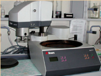
Einrichtung zur Probenpräparation für die Lichtmikroskopie
