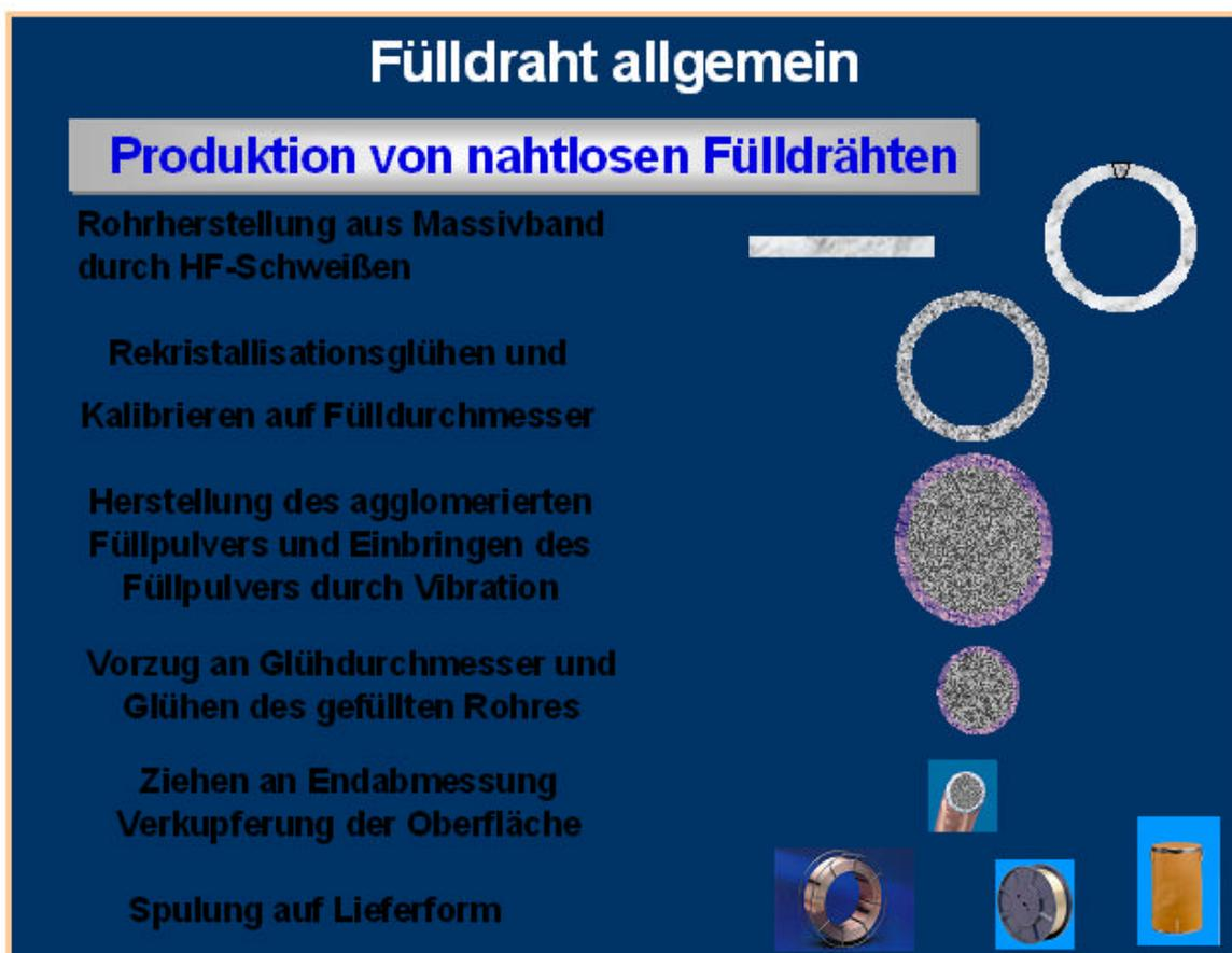
**Bild 5.1:** Schematische Darstellung der Herstellung nahtloser Fülldrähte
