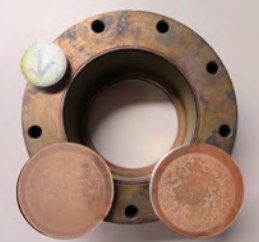
Für die REM-Analyse präparierte Filter
